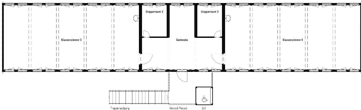
Bild 3: Grundriss neues Obergeschoss Schulraumprovisorium
