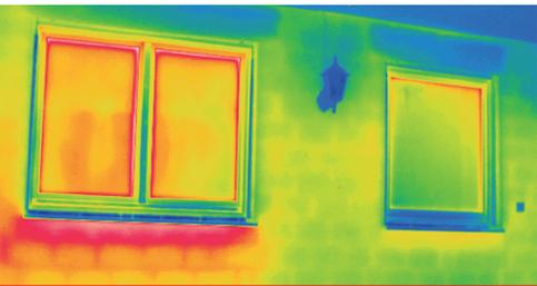
Infrarotaufnahmen Ihres Hauses im Aussenbereich geben wertvolle Hinweise auf mangelhafte Wärmeisolierung oder Wärmebrücken.
