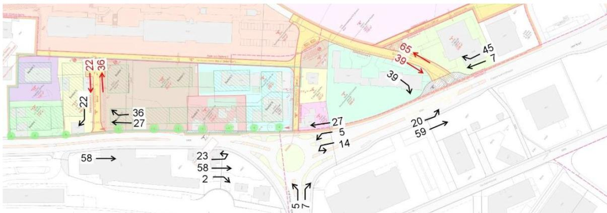
Abb. 20: zusätzliche Fahrten beim Kreisel zur Abendspitze (Fz/h); Quelle: SNZ Ingenieure + Planer AG
