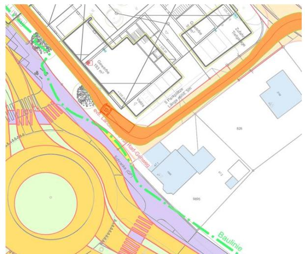
Abb. 3: Anlieferung mit Schleppkurve im Falle Landbedarf ASTRA (Quelle: Marti Gesamtleistungen)
