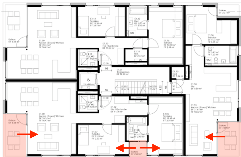
Loggias mit seitlichen Lüftungsfenstern (Haus C + D)
